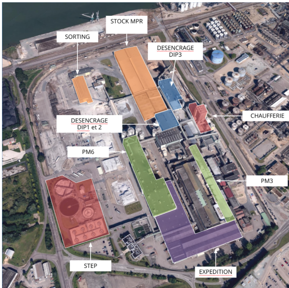
Figure 3 : Outils de production en place sur le site
